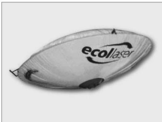
Figura 9. Esempio di minidirigibile radio-controllato, a sagoma discoidale. Il velivolo viene utilizzato per foto aeree o trasporto di piccoli oggetti). Fonte: http://www.endoacustica.com/details_bl_51_en.htm
